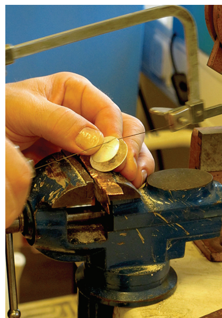
Utsågning i bottenplattan på stolpknappen, en skåra som underlättar knäppningen.
