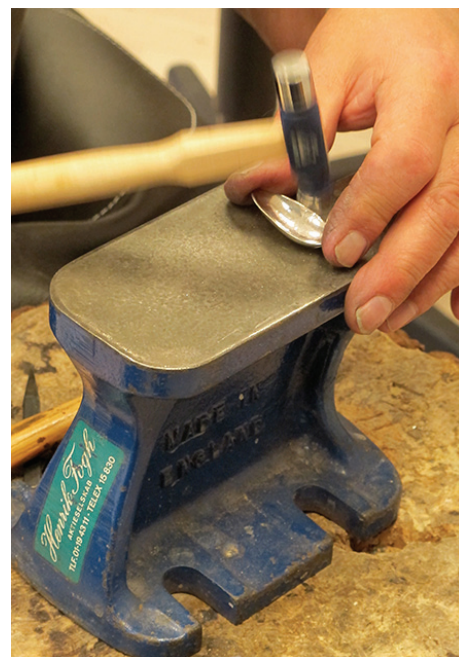
En stolpknapp till kragen blir till. Övre delen av knappen kupas med hammare.
